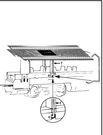
Den Kontaktbügel unten lose einführen, oben über die Kante der Leiterplatte einhängen und abschließend am Punkt **e** fest einrasten. Der Kontaktbügel muss im Schlitz **f** liegen.
