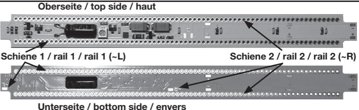
Wenn die Leiterplatte nicht über die Kontaktbügel angeschlossen werden kann, besteht auch die Möglichkeit sie mit Litzen an den Lötpunkten anzuschliessen.
