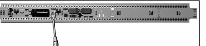
Mit einem geeigneten Schraubendreher kann die gewünschte Helligkeit am Potentiometer eingestellt werden.
