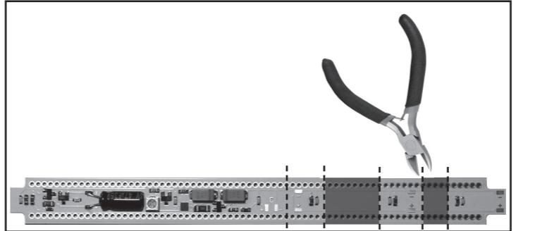
Wird die Leiterplatte in kürzere Wagen eingebaut, muss sie an den vorgesehenen Stellen gekürzt werden. Mit einem Seitenschneider oder einer Schere schneidet man die Leiterplatte auf die benötigte Länge. Der Einbau erfolgt auf die im Folgenden beschriebene Weise.
